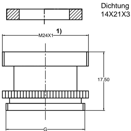
G - Anschlußgewinde für Anschluß an das Umschaltventilgewinde ( eigentlich 55/64 x 27 i ; entspricht 21,8 x 0,94 i --> angenähert und paßfähig bei ca. 2 Gewindegängen zu M22 x 1)
